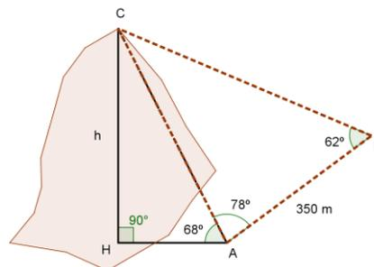
En el triángulo ABC hallamos el ángulo en la cima C:  $C = 180^\circ - (78^\circ + 62^\circ) \Rightarrow C = 40^\circ$ .
