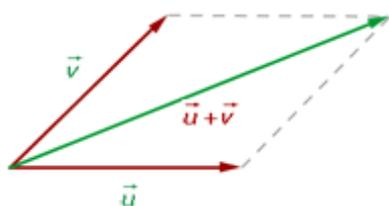
**Regla del paralelogramo:** Se toman como representantes dos vectores con el origen en común, se trazan rectas paralelas a los vectores obteniéndose un paralelogramo cuya diagonal coincide con la suma de los vectores.
